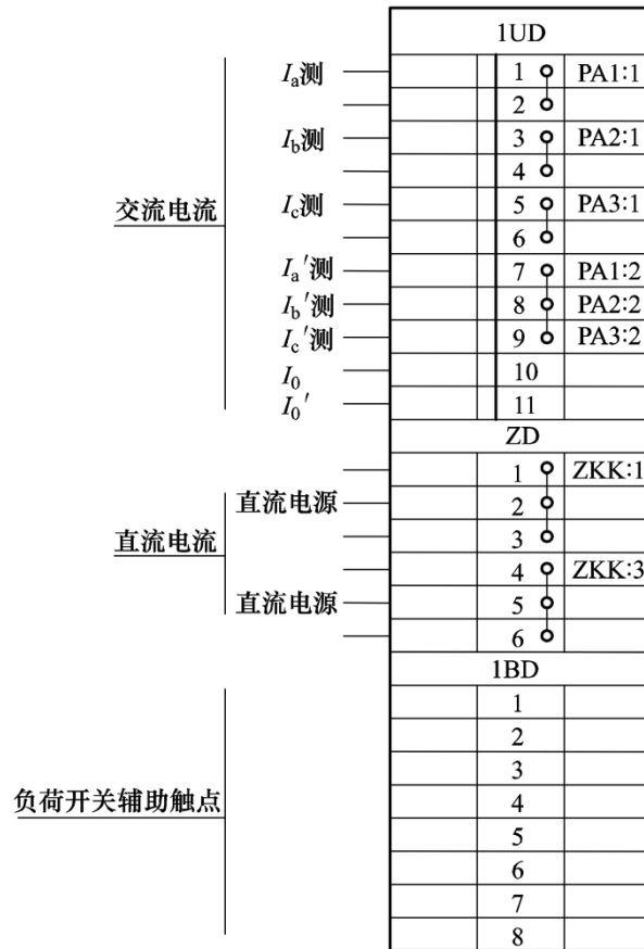
图 1 进、出线柜端子排图
